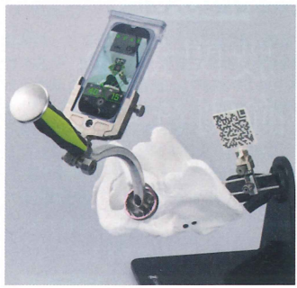
人工股関節全置換術で使用するARナビゲーションシステム「AR Hip」（ばんだね病院提供）
